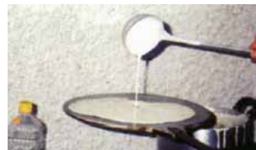
Si versa la colla preparata almeno 2-3 ore prima: con abili rotazioni del polso si stende la colla fino a ricoprire l'intera cottola.
